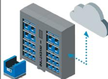
Skalierbares Automaten-system zur Bestandsverwaltung mit sicherem Zugang und Produktausgabe. Das iVendScale-System protokolliert die über die Waage erfassten Bestandsdaten bei der Ausgabe von Produkten.
